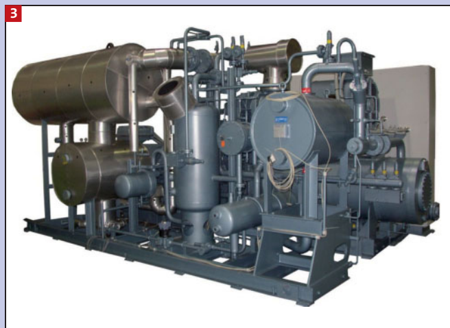
3 Zweistufige Wärmepumpe mit Schraubenverdichtern und Plattenwärmeübertragern zur Erzeugung von 70°C Warmwasser, Hersteller GEA Grasso
